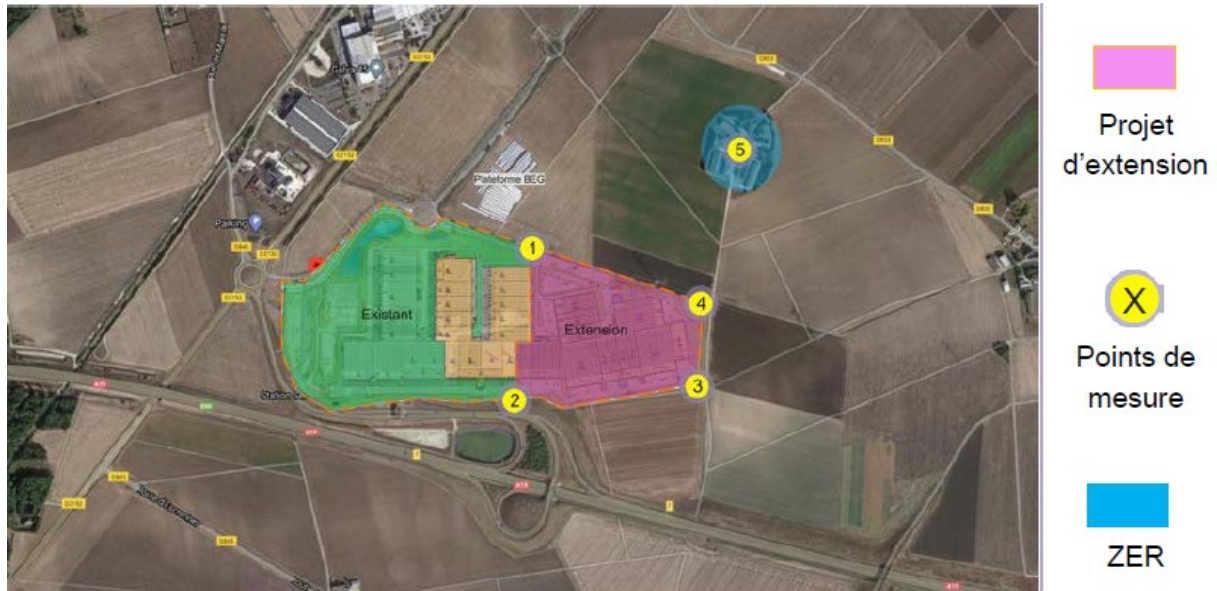
Figure 40 : Emplacement des points de mesure de l'étude acoustique initiale
